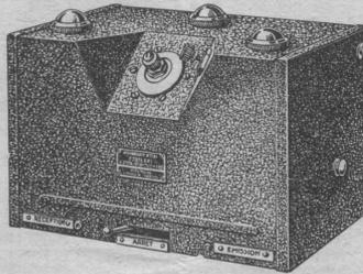
**CIRQUE-RADIO** vient de se rendre acquéreur AUX DOMAINES d'un gros stock de postes Émetteurs-Récepteurs, Portatifs, Batteries. LONGUEURS D'ONDES : de 46 à 55 Mc/s (5,5 à 6 m. 50). PORTÉE APPROXIMATIVE : 4 à 6 kilomètres sur plat, et 20 kilomètres en montagne à vue. Équipé de 2 LAMPES DOUBLES (1 1J6 et 1 1E7). Antenne verticale « DIPOLE » DEMI-ONDE. Fonctionne avec 1 PILE BA39, 2 PILES IV5 avec 1 résistance de 5 ohms, 1 watt en série, 1 CASQUE 2 ÉCOUTEURS, 1 MICROPHONE CHARBON.
