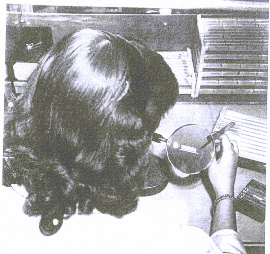
Abb. 51. Unmittelbar vor dem Einbau werden die Gitter mit Hilfe eines Vergrößerungsglases kontrolliert. Wenn notwendig, werden sie noch einmal in Alkohol gereinigt und dann in einen staubdichten Behälter gelegt.
