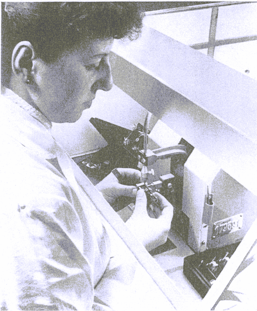
Abb. 32. Die Montage des Elektroden-Aufbaues erfolgt in allseitig geschlossenen staubdichten Kästen, die durch ein Luftzuführungsrohr unter geringem Überdruck gehalten werden. Die Arbeiterin steckt ihre Hände bei der Montage durch einen Plastikvorhang. Links an der Schweißmaschine sind Magnete zum Festhalten kleiner Einzelteile zu erkennen.
